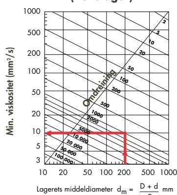
Eksempel: Lagerets middeldiameter  $d_m = 200$  mm, omdreiningshastighet  $n = 1000$  1/min. Korrekt minimums viskositet ved en gitt driftstemperatur avleses som skjæringspunktet mellom hastighet og middeldiametren. (I eksemplet således 10 mm<sup>2</sup>/s).
