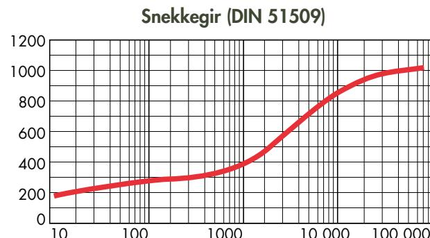
$$\text{Belastning-hastighetsfaktorer} = \frac{T_2}{n \alpha^3} \left( \frac{N \cdot min}{m^2} \right)$$
